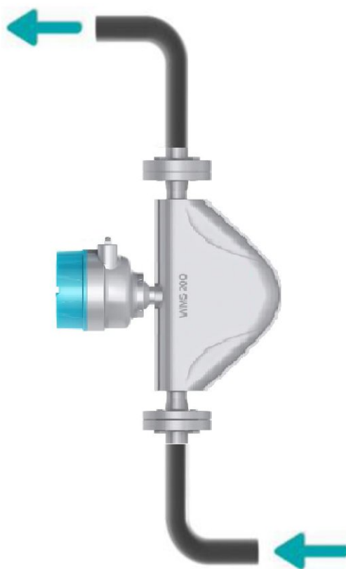
Рисунок 12 – Вертикальный монтаж расходомера серии WMF-200
