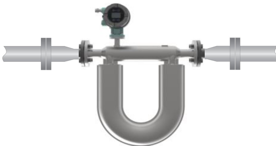
Рисунок 19 - Монтаж расходомера с трубопроводными конфузорами и диффузорами
