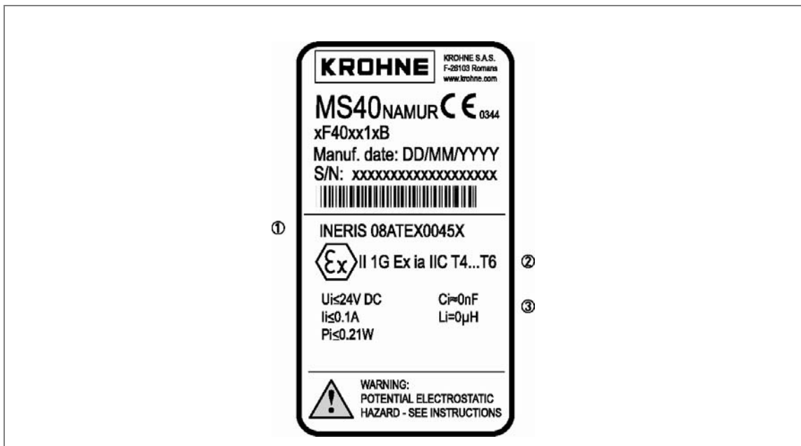
Рисунок 9-2 Типовая табличка Ex I для сигнализатора уровня (Namur)
