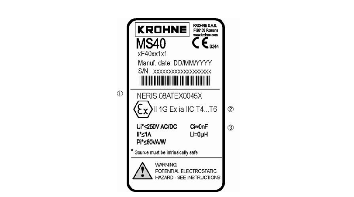
Рисунок 9-1 Типовая табличка Ex I для сигнализатора уровня (не по стандарту Namur)
