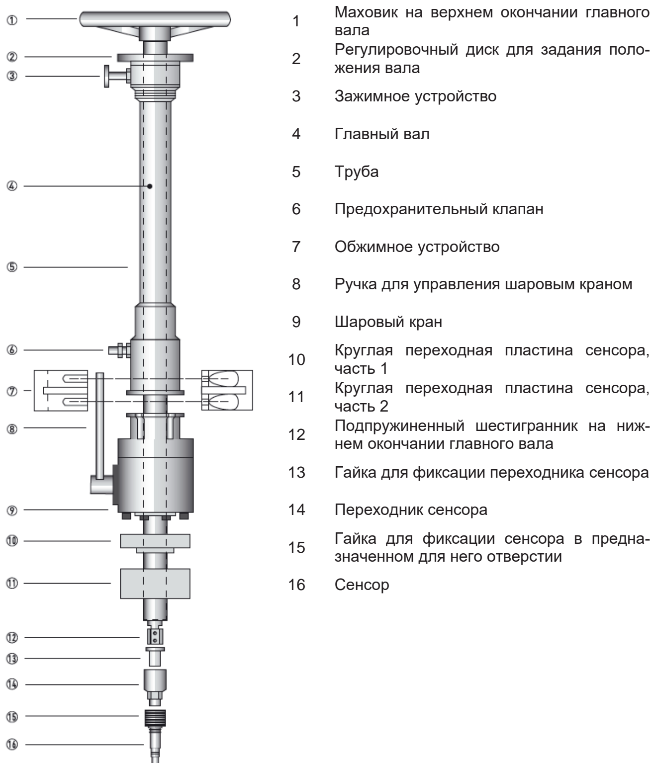
Рисунок 2.16 – Инструмент для замены сенсоров
