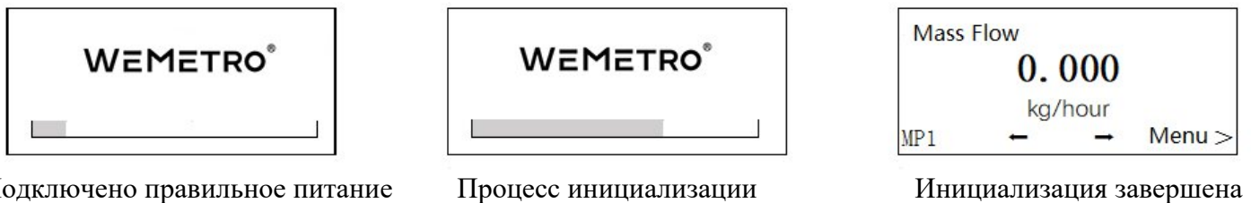
Рисунок 12 – Последовательность инициализации (отображение на дисплее)
