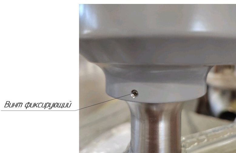
Рисунок 5 – Поворот корпуса преобразователя сигналов WMC-30
