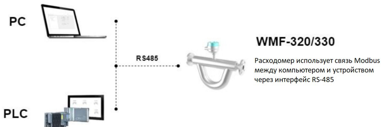
Рисунок 10 – Варианты работы расходомера с преобразователем сигналов WMC-30
