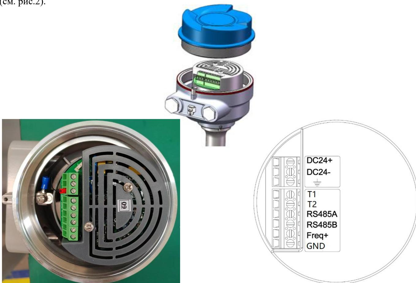
Рисунок 2 – Клеммы подключения преобразователя сигналов WMC-20
