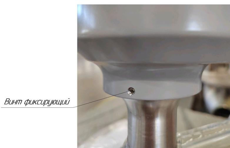
Рисунок 5 – Поворот корпуса преобразователя сигналов WMC-20
