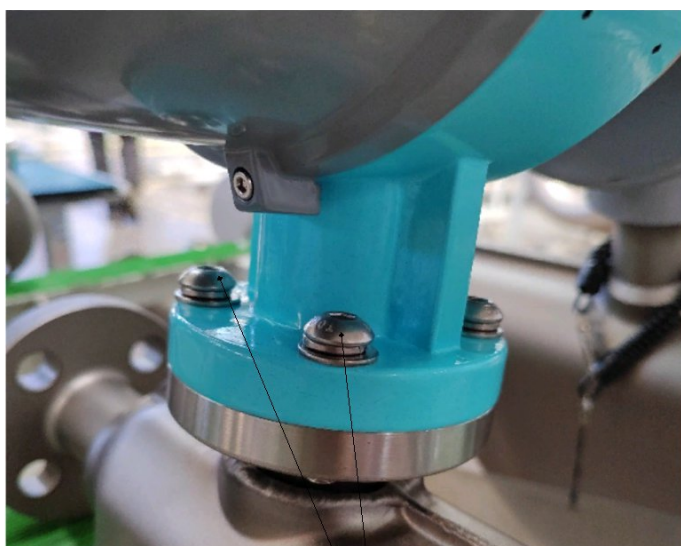
Винты крепления корпуса WMC-10 с фланцем ППР
