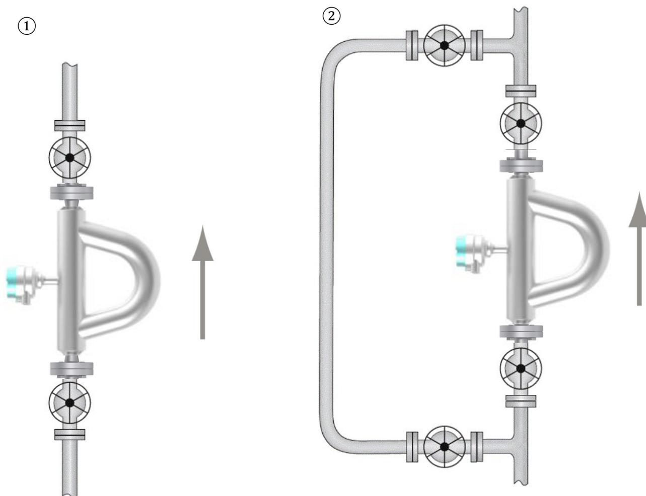
Рисунок 19 - Калибровка нулевой точки
