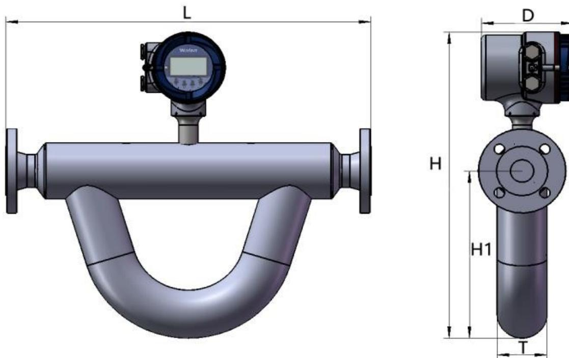
Рисунок А2 - Габаритные размеры WMS-300 с WMC-401
