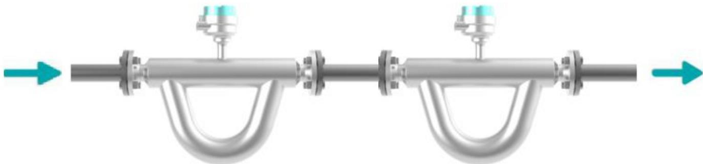
Рисунок 16 – Последовательное расположение расходомеров серии WMF-300
