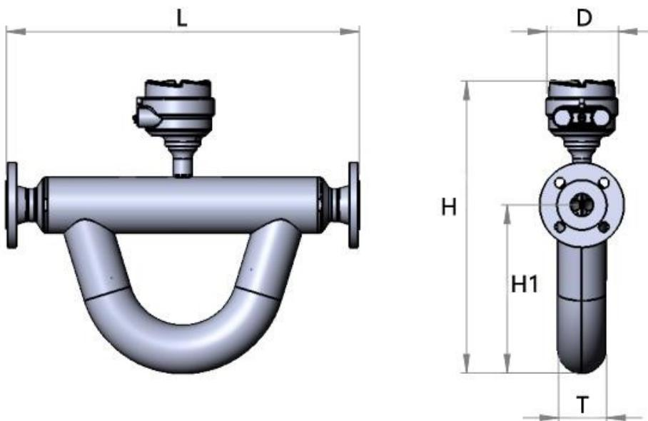
Рисунок А3 - Габаритные размеры WMS-300A/D с WMC-10A/D, WMC-20A/D и WMC-30A/D
