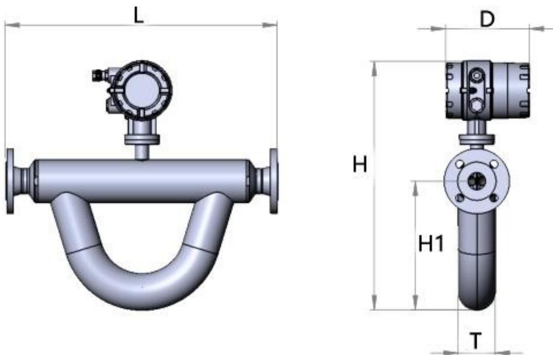
Рисунок А1 - Габаритные размеры WMS-300 с WMC-101
