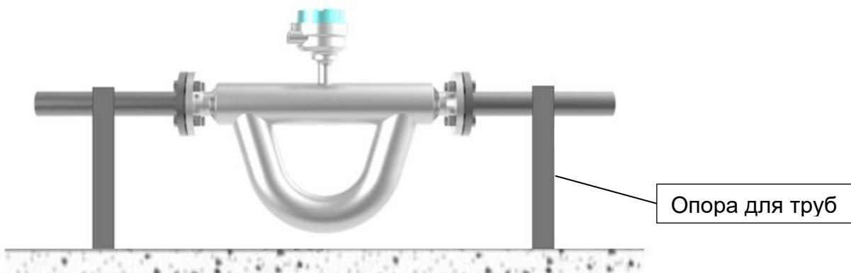
Рисунок 9 – Размещение опор для расходомеров
