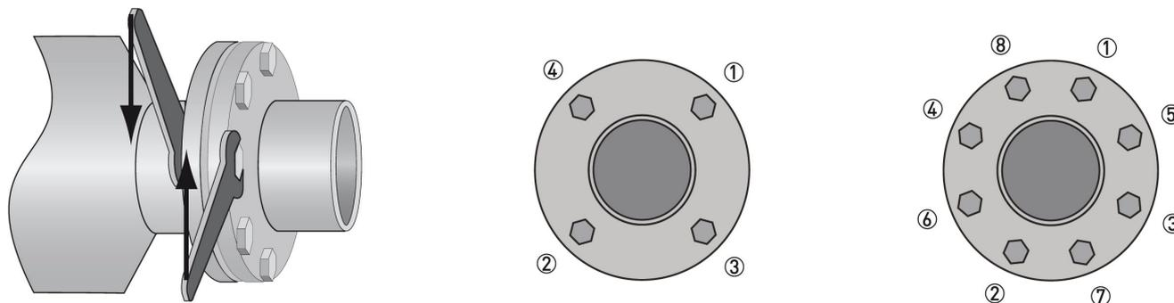
Цифрами обозначены примеры порядка затяжки гаек попарно по диагонали с равномерным усилием для фланцев с четырьмя и восемью отверстиями.
