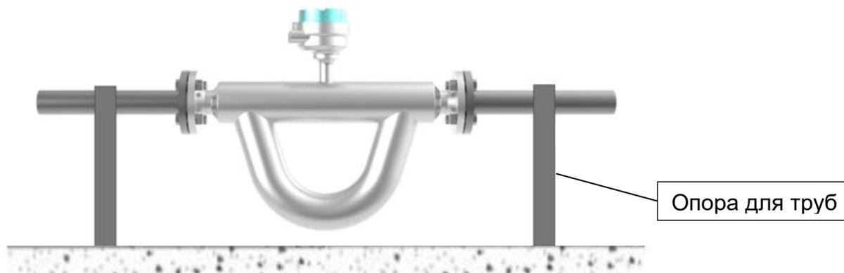
Рисунок 9 – Размещение опор для расходомеров
