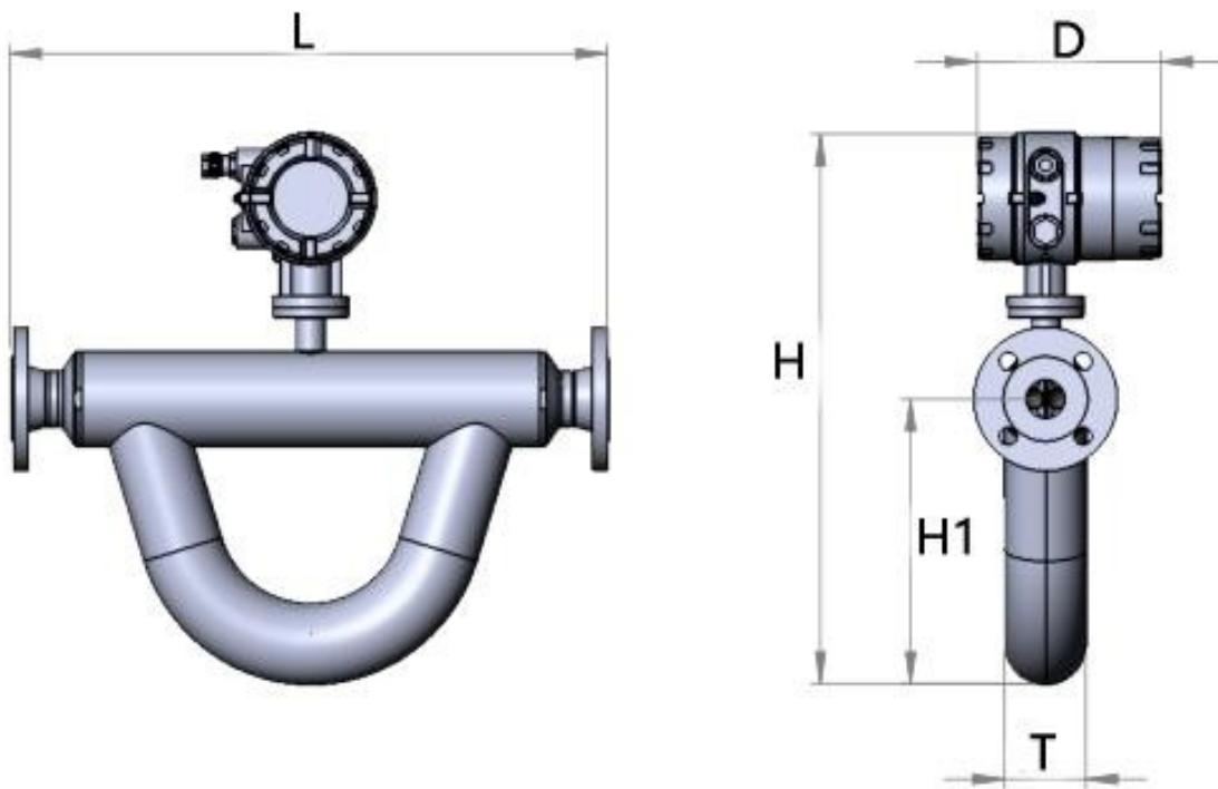
Рисунок А1 - Габаритные размеры WMS-300 с WMC-10I
