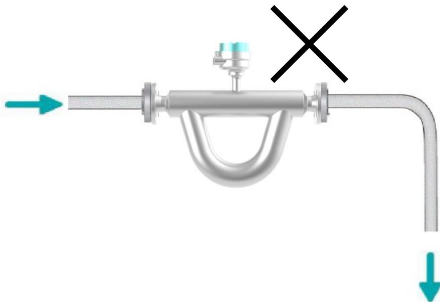
Рисунок 14 – Монтаж расходомера перед нисходящим участком большой длины
