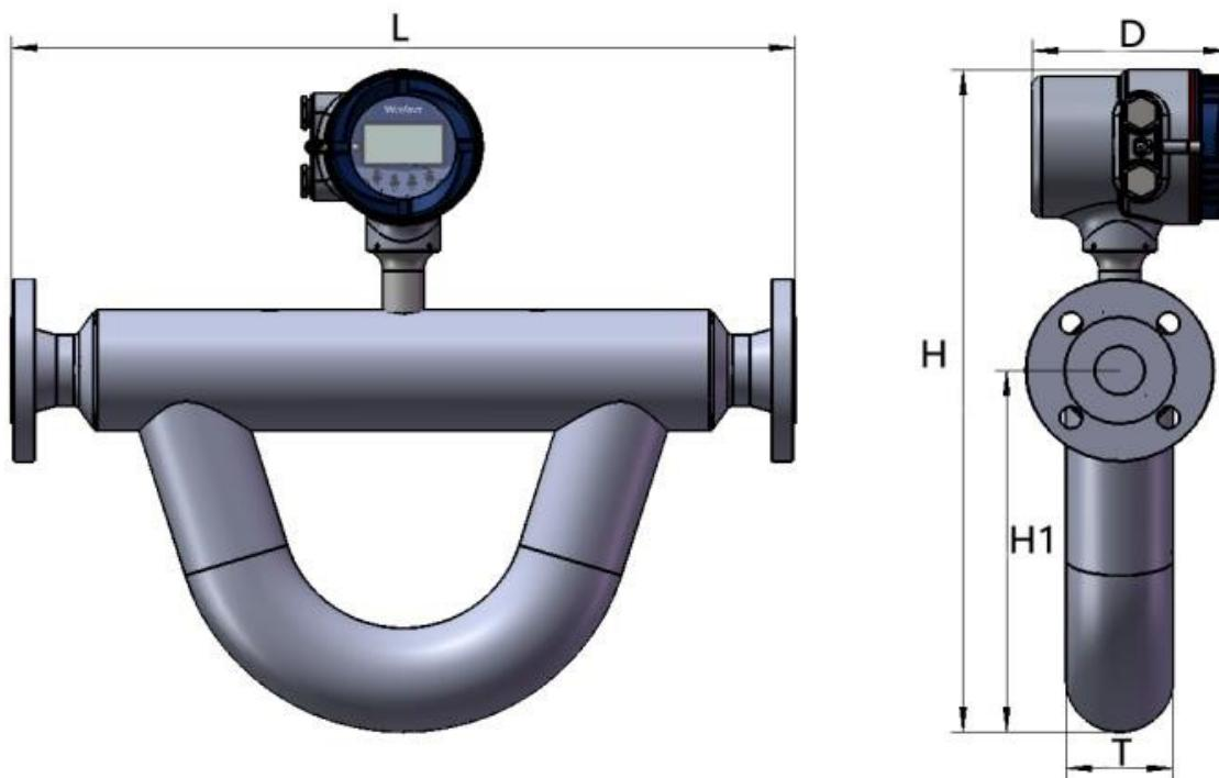
Рисунок А2 - Габаритные размеры WMS-300 с WMC-40I
