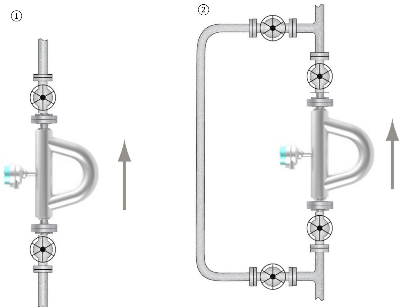
Рисунок 19 - Калибровка нулевой точки
