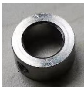
Рисунок 8 – Ограничительное кольцо поплавка с жестким стержнем
