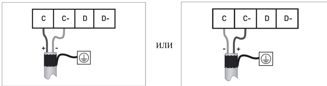
Рисунок 2 - Подключение к ответвлённой шине
